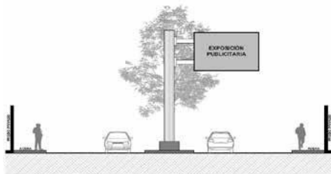
Figura 4. Tipo D: Voladizo - Publicidad o propaganda exterior en medianas o bandas centrales (parterres)
